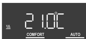
рисунок 2: Индикация заданной температуры в автоматическом режиме
